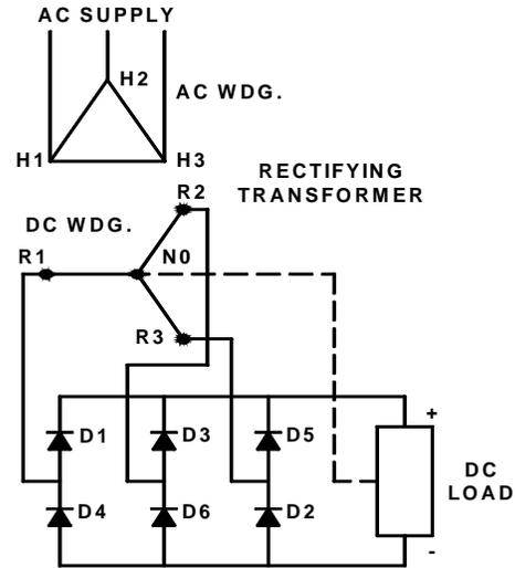
Fig 4 - Three Phase Rectifier
