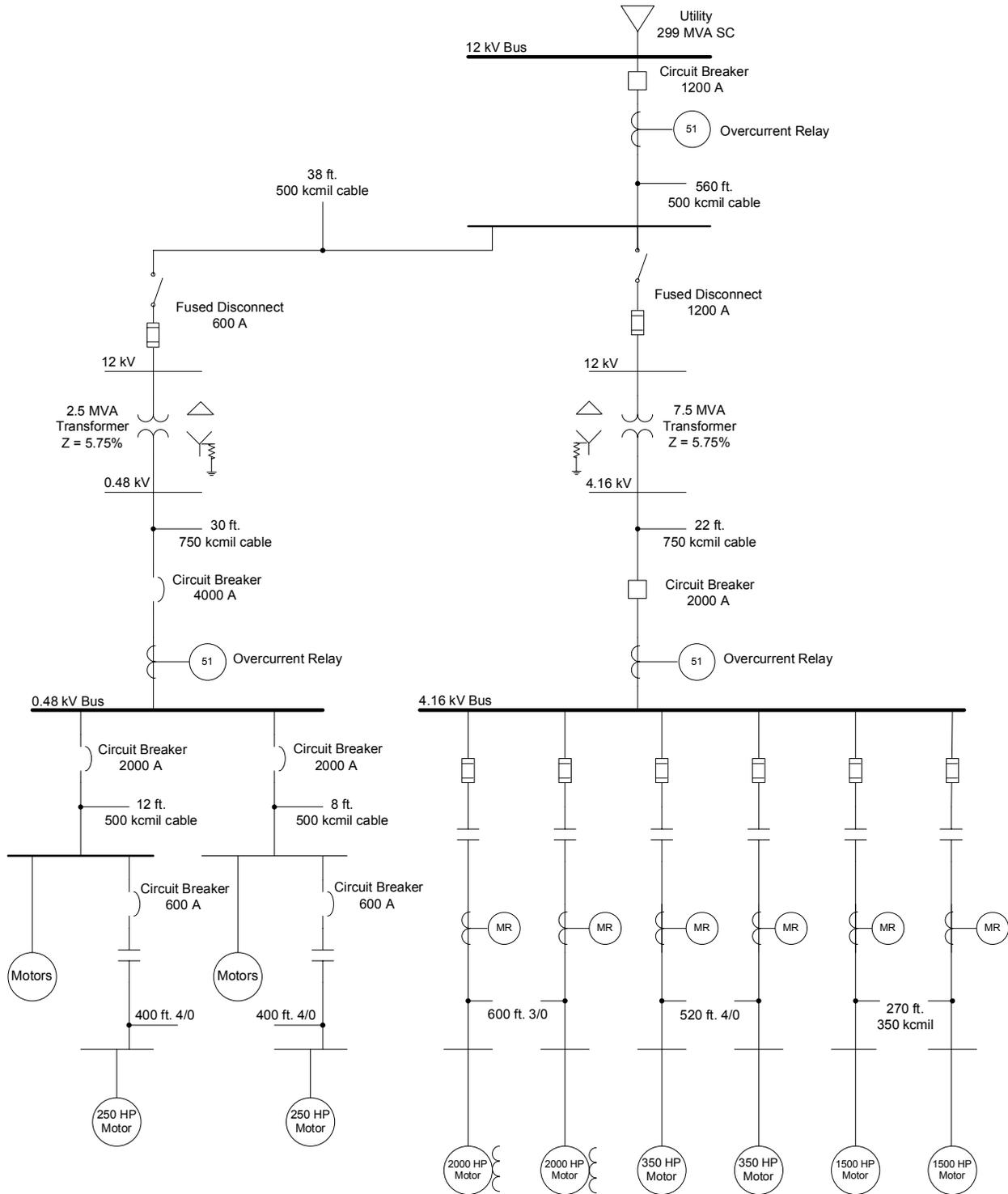
**Fig. C-1: PETROCHEMICAL FACILITY SIMPLIFIED ONE- LINE DIAGRAM**
